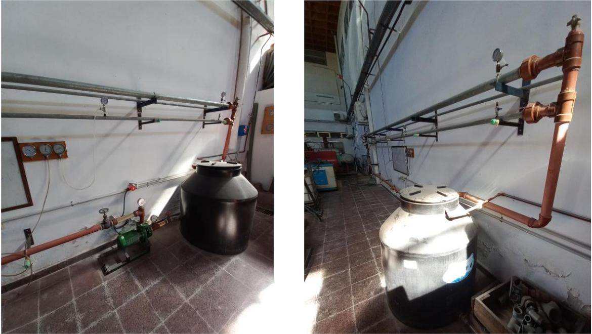
Figura 12.10: Vista general (desde dos ángulos) del banco de pruebas hidráulicas desarrollado en la FRSF-UTN.
